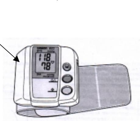
Slika 1: Izgled tlakomjera tip Omron RX2 s prikazom mesta za smještaj ovjerne naljepnice
